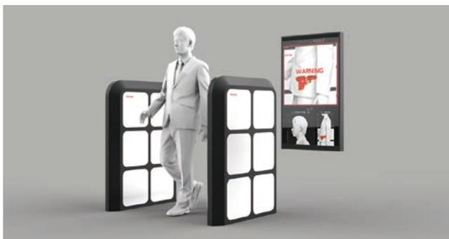
利用毫米波雷达模块开发出穿行式危险品检测系统
